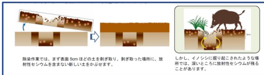
図 6 除染後に地中に Cs が残る理由（飯舘村除染効果検証報告書より）
