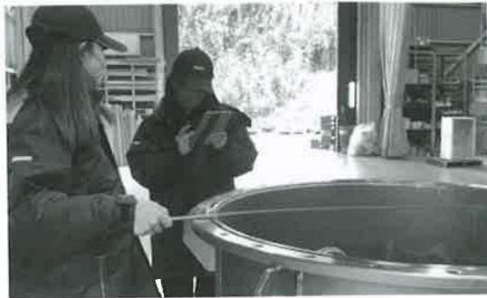
写真2 HIPAX Iを用いて搬入された部材の確認を行う様子
