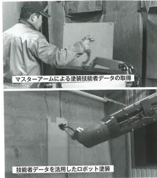
写真4 マスターアームによる技能データ取得の様子とデータを活用したロボット塗装テスト
